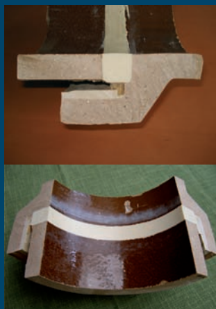
Bild 2+3: Werkstückprobe einer mit EDS-Verfahren erneuerten Dichtung
